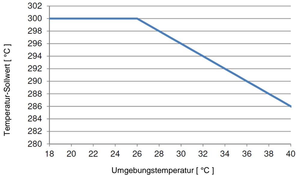
Abb. 10: Maximaler Temperatur-Sollwert in Abhängigkeit von der Umgebungstemperatur
