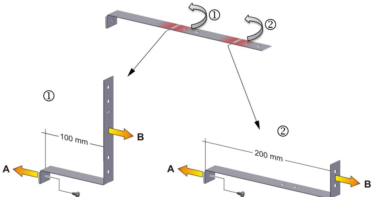
Abb. 8: Variable Länge des Kippschutzhalters je nach Biegung
