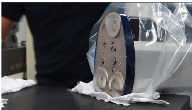
13. Dégraisser prudemment la surface de la base de l'instrument. A cet effet, utiliser un solvant ne contenant aucun agent agressif.
