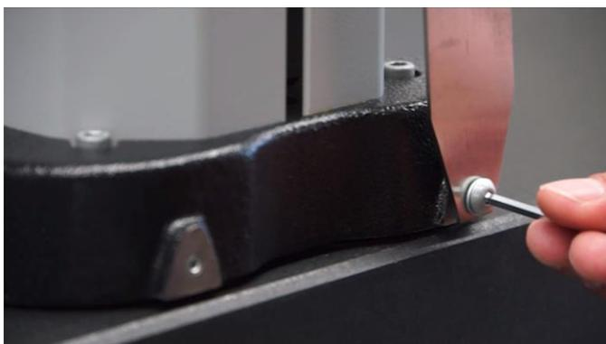
21. Démonter le support de maintien en le couissant délicatement sur la mousse autour de l'axe de fixation du porte-touche.
