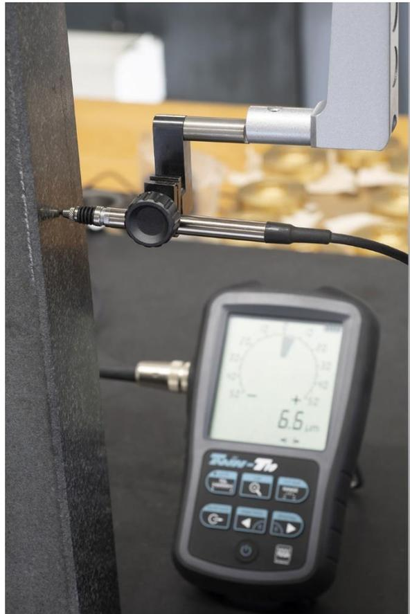
Une fois que le chariot de support a été bloqué le montage du système palpeur-support peut se réaliser comme décrit sur la photo ci-dessus (par exemple).
