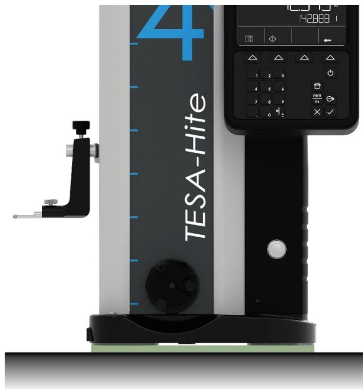
L'épaisseur du coussin d'air est réglée en fonction de la qualité de la surface du marbre. Ce réglage peut s'effectuer via le logiciel de commande.
