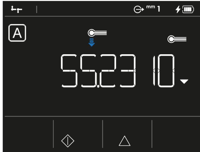
Résultat de mesure issu d'un palpage vers le bas en mode ST1
