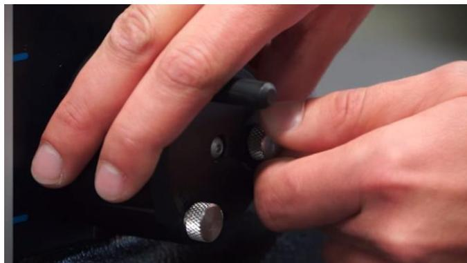
25. Positionner l'axe de fixation du porte-touche à une hauteur confortable pour procéder à la fixation des accessoires et bloquer à nouveau le chariot.
