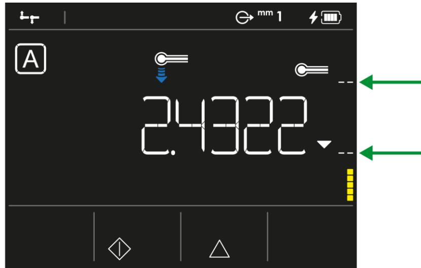
La marque inférieure, lors d'une mesure vers le bas de la touche de palpation, correspond à la pression minimum nécessaire pour qu'un palpation simple soit pris en compte. Si la pression n'est pas suffisante, la barre est jaune. Passé la marque horizontale, elle devient verte ou même rouge si la pression exercée est trop forte (en-dessus de la marque supérieure).
