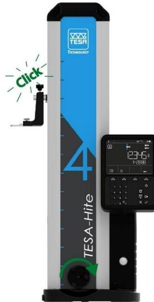
Le logiciel a maintenant reconnu automatiquement le blocage du double chariot et l'affichage s'actualise en temps réel en fonction du déplacement de la touche.
