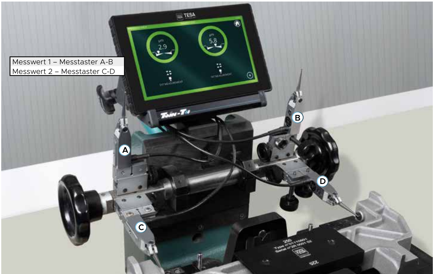
Parallelitätsprüfung mit elektronischen Hebelmesstastern GT31.
