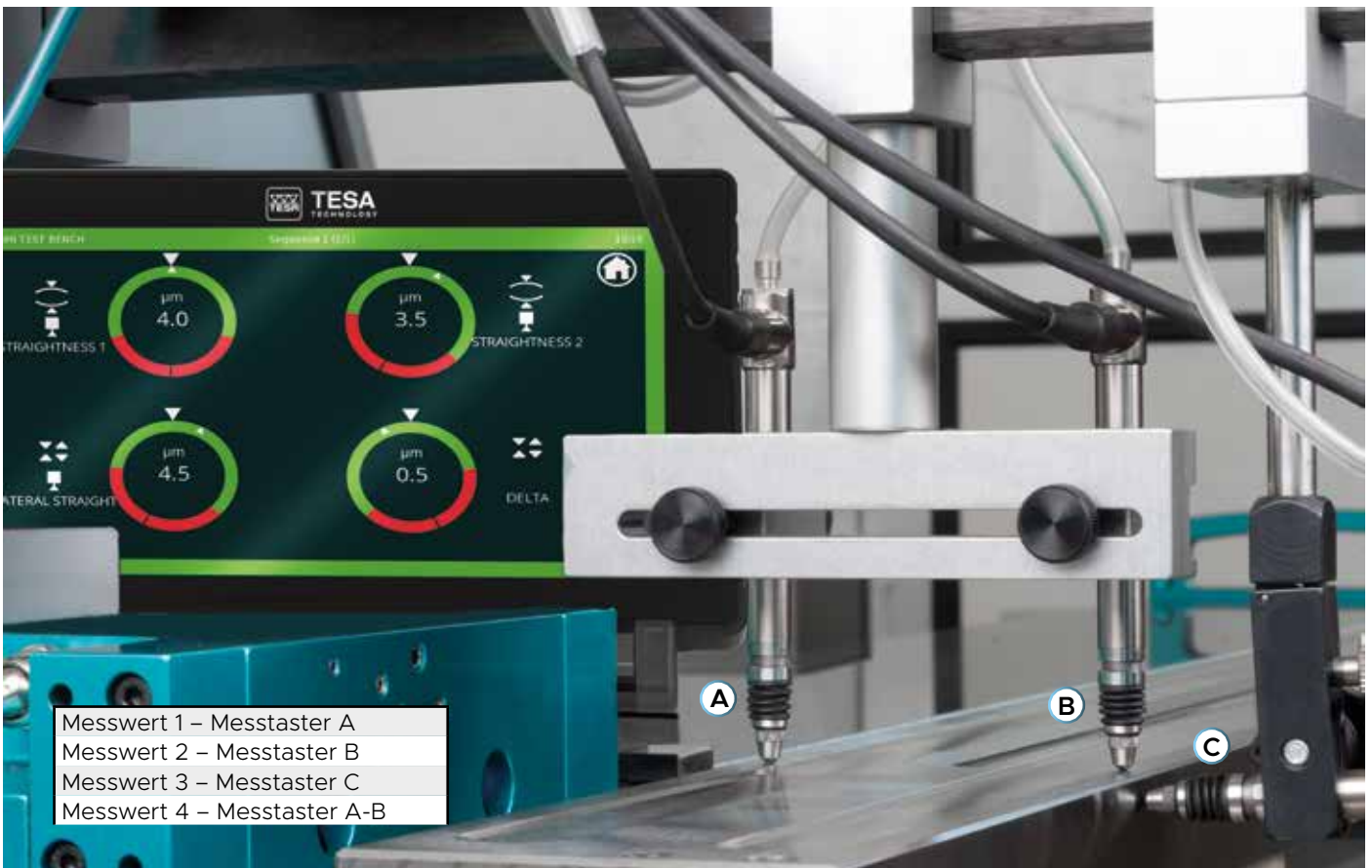
Ebenheitsmessung gleichzeitig auf zwei Achsen.
