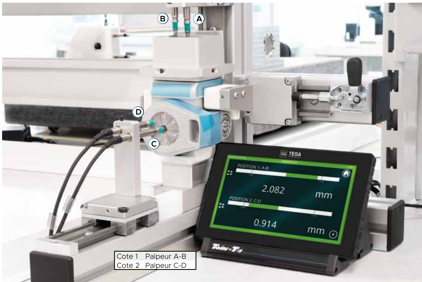
Contrôle de position lors d'une opération d'assemblage
