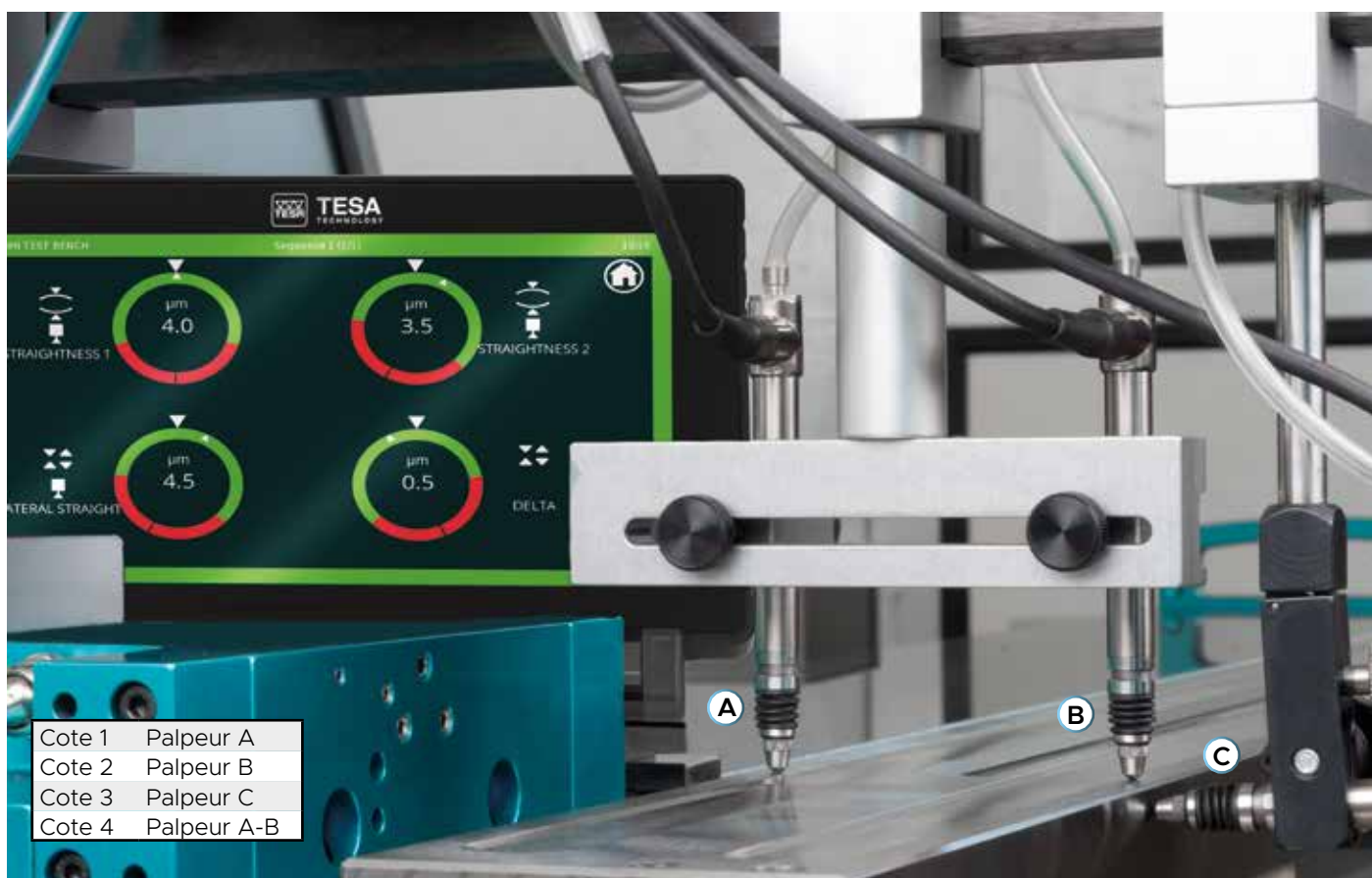
Mesure de planéité sur deux axes simultanément.
