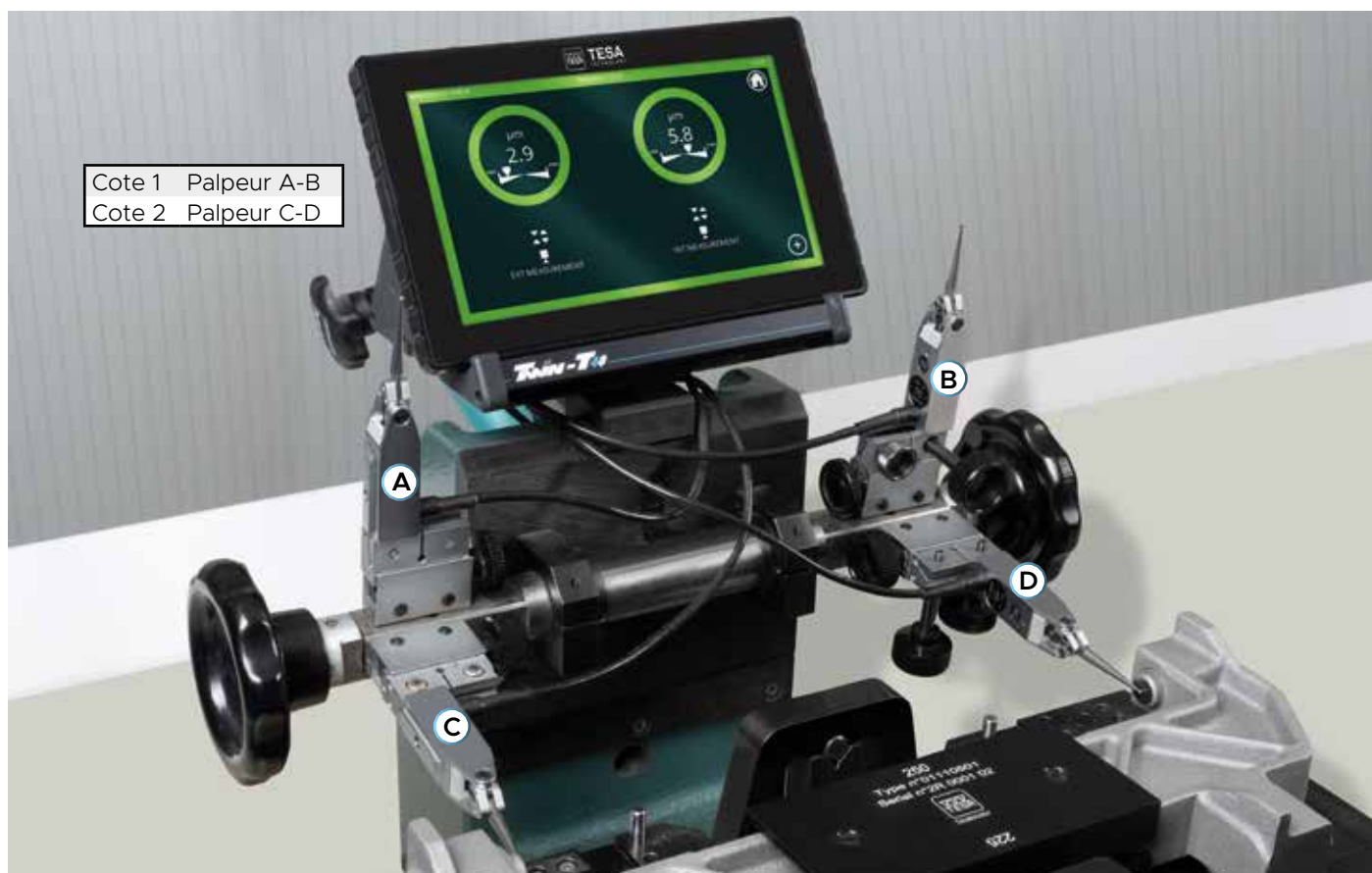
Contrôle de parallélisme avec des palpeurs à levier électroniques GT31.
