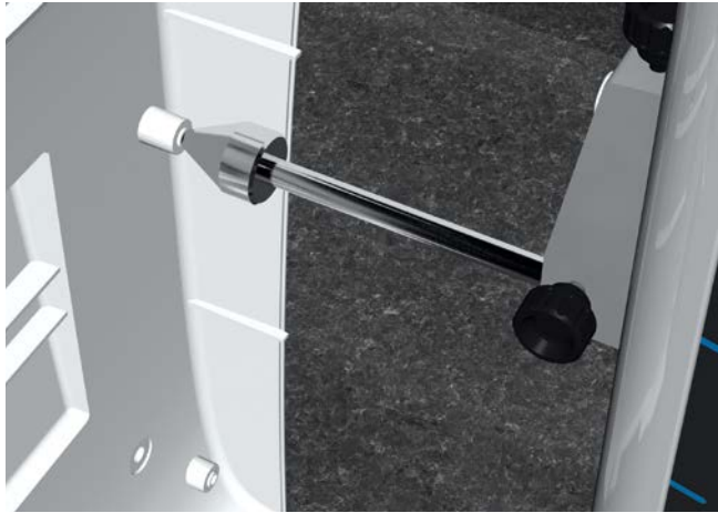
Messung des Achsabstands an einem elektronischen Plastikgehäuse
