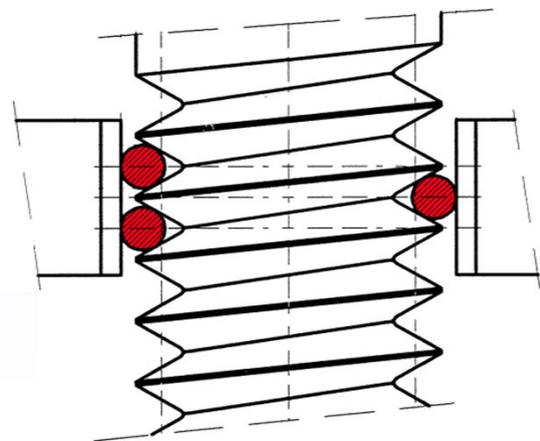
Les piges pour mesure de filetages montées sur supports combinent ce procédé avec un confort d'utilisation unique, une sécurité de mesure très grande, et une rentabilité optimale.
