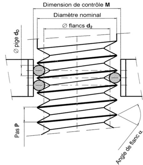
**Calcul de la dimension de contrôle M<sub>1</sub> :**
