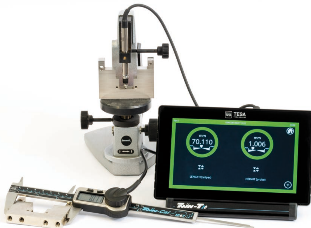
Contrôle de 2 cotes fonctionnelles, l'une avec un palpeur inductif TESA et l'autre avec un pied à coulisse connecté sur l'afficheur
