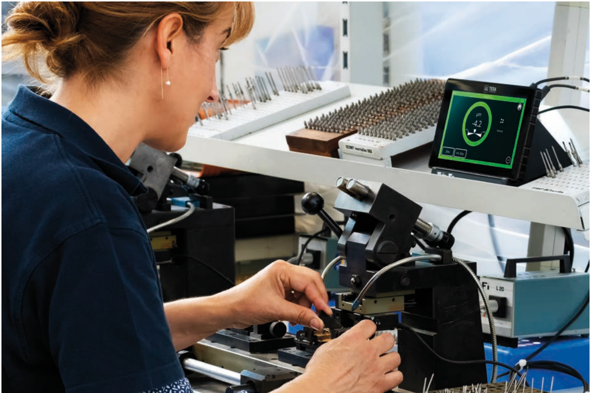
Mesure de concentricité avant assemblage de pièces cylindriques
