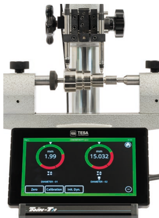
Mesure de deux battements lors de la même opération de contrôle
