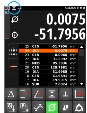
2. Für jede Höhen-, Durchmesser- oder Achsabstandsmessung, deren Toleranzen aktiviert wurden, wird die entsprechende Buffer-Zeile in einer dem Ergebnis entsprechenden Farbe angezeigt:
