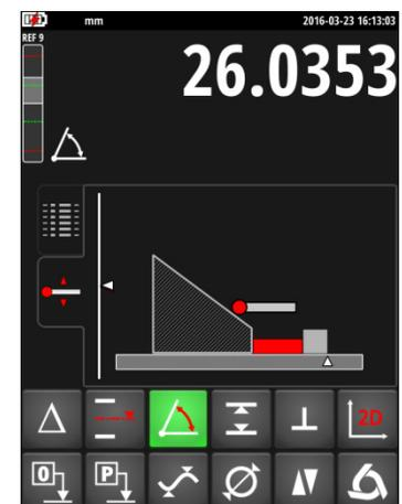
3. Entfernen Sie das parallele Distanzstück und führen Sie die zweite Messung mithilfe der Anschlagleiste durch, wie auf dem Bildschirm angezeigt. Zur Messung des Kegels suchen Sie den Umkehrkehrpunkt, indem Sie das Werkstück oder das Gerät senkrecht zur Achse des Tasters verschieben, während Sie die Entfernung zwischen Gerät und Werkstück konstant halten.
