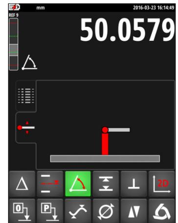
6. Der Winkelwert wird in dem Buffer angezeigt und gespeichert. Nun kann eine weitere Winkelmessung durchgeführt werden.
