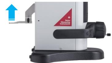
2. Um die Dicke und Durchbiegung des Tasters während der Messung nach oben oder nach unten (invertierte Fläche, Durchmesser) zu kompensieren, fordert das Gerät die Aufnahme der Tasterkonstante an. Der Wert der zuletzt gespeicherten Konstante wird angezeigt.
