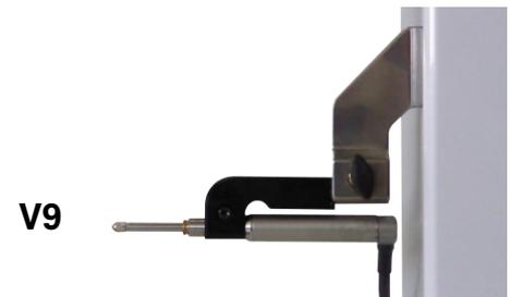
3. Placer la pièce à mesurer contre le palpeur en veillant à ce que le contact soit garanti sur toute la partie à mesurer. Amener le chariot à sa position de départ.
