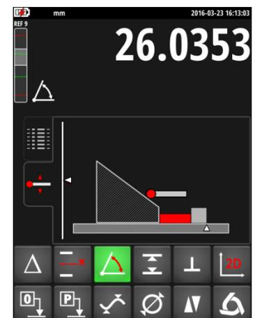
3. Retirer la cale parallèle et effectuer la seconde mesure à l'aide de la pièce d'appui comme indiqué à l'écran.
