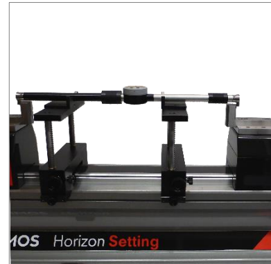
Einstellen von 2-Punkt-Vergleichsmessgeräten (TEL5, TELMA7, TELMN7.2)
