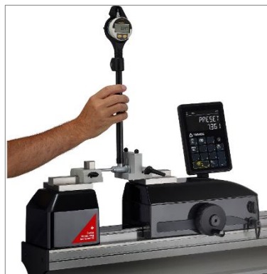
Manuelles Einstellen von 2-Punkt-Bohrungsmessgeräten (TA-SU-301, TEL5)
