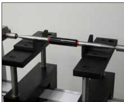
Etalonnage de tiges-étalons
