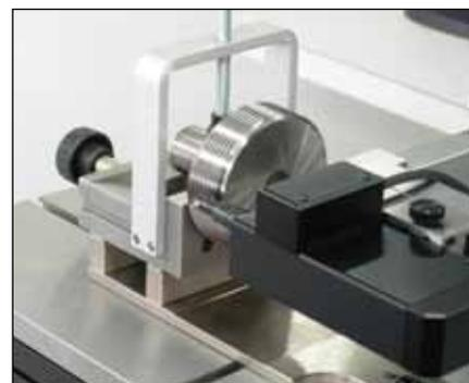
Etalonnage de tampons à filetage
