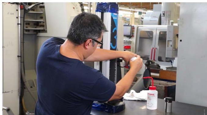
16. Entfernen Sie vorsichtig das Klebeband vom Gussfuß, vom Handgriff und von der Abdeckklappe am oberen Teil des Geräts.
