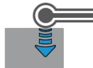
4. Sobald der Messeinsatz die zu messenden Stelle erreicht, hält das System die Messkraft konstant. Nach einer Stabilisierungsphase wird der Messwert erfasst und am Bedienpult angezeigt. Die LED leuchtet gleichzeitig mit dem Ertönen des Pieptons kurz auf und signalisiert das Ende der Messung.
