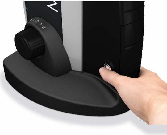
Durch Drücken des Schalters für die elektrische Pumpe baut sich sogleich zwischen Messgerät und Prüfplatte ein nur wenige Mikrometer dickes Luftkissen auf (violett markierter Bereich hierunter).
