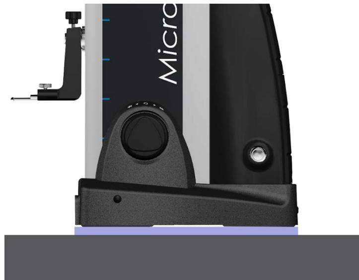
Die Höhe des Luftkissens wird je nach Beschaffenheit der Prüfplatte eingestellt. Diese Einstellung kann über die Bediensoftware erfolgen (für weitere Details lesen Sie dieses [Kapitel](#)).
