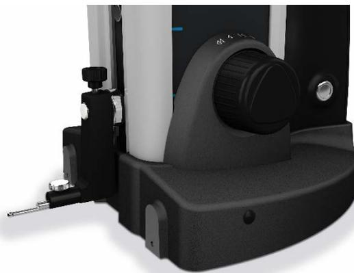
Durch seine intuitive Verwendung ist dieses Gerät einfach und präzise in der Handhabung. Außer Schnellvorschub und langsamem Anfahren der Messstelle kann auch das Antasten nach oben oder unten oder die Messung einer Bohrung durch einfaches Drehen am Verstellrad erfolgen.
