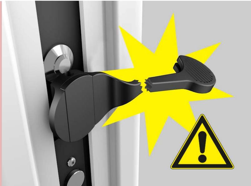
Dieser Griff wird zum manuellen Verstellen des Tasters zwischen zwei Messbereichen verwendet. Er ist sehr zerbrechlich und es darf keinerlei Kraft auf ihn ausgeübt werden, außer zum normalen Verstellen während eines Messvorgangs.
