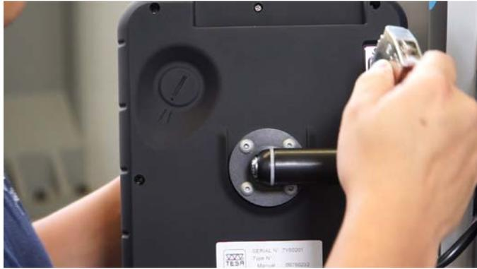
24. Überprüfen Sie, dass der Akku richtig in das Höhenmessgerät eingesetzt ist.
