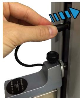
6. Die Feststellschraube lösen. Der IG13 kann jetzt verwendet werden.
