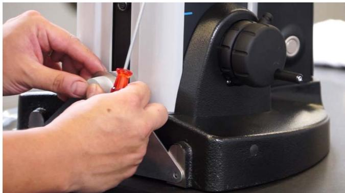
19. Den Achsenschutz zur Befestigung des Messtasterhalters entfernen.
