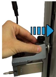
5. Verbinden Sie den IG13 mit dem Höhenmessgerät.
