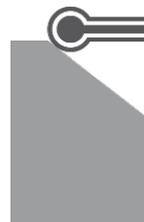
3. Ein Endmaß (+ Zwischenstück) zwischen Werkstück und Gerät platzieren. Auf
