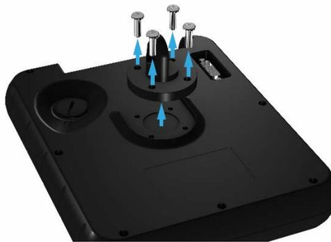
2. Halten Sie den Drucker und das Bedienpult in der richtigen Position, damit Sie die 4 Schrauben wieder fest drehen können.
