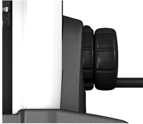
Dieser Ring wird hauptsächlich bei der Messung von Bohrungen oder Achsen (statischer Prozess) verwendet, damit die Umkehrpunkte bestimmt werden können. Er wird ebenfalls verwendet, um jegliches Verstellen des Schlittens beim Transport des Systems zu verhindern.
