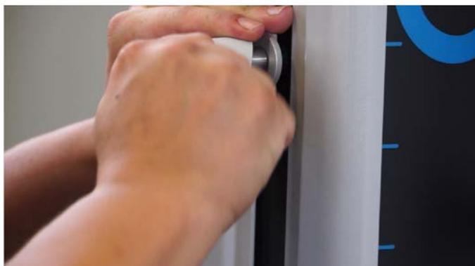
20. Den Halter mit seinem Messtaster auf der Achse befestigen.
