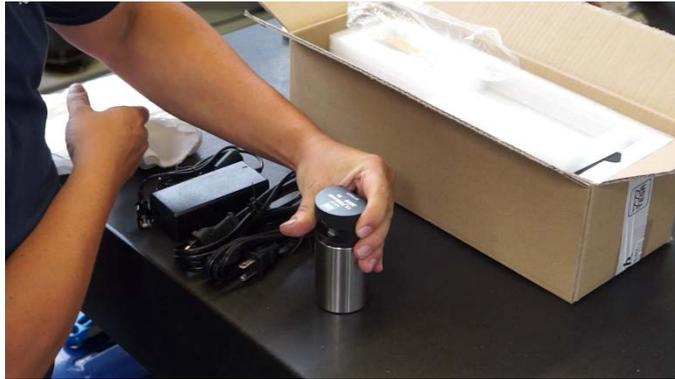
5. Entnehmen Sie den Messtasterhalter und den Messtaster. Befestigen Sie den Messtaster an seinem Halter. Vergessen Sie nicht, den Messtaster mithilfe der Feststellschraube zu fixieren.
