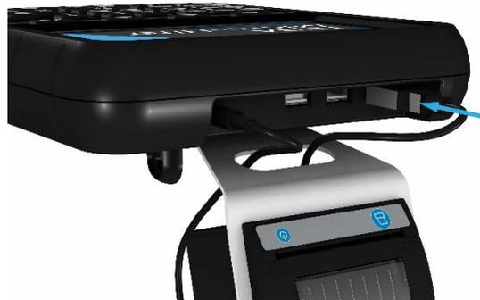
4. Zur Stromversorgung des Druckers muss das zweite Kabel ebenfalls angeschlossen werden.
