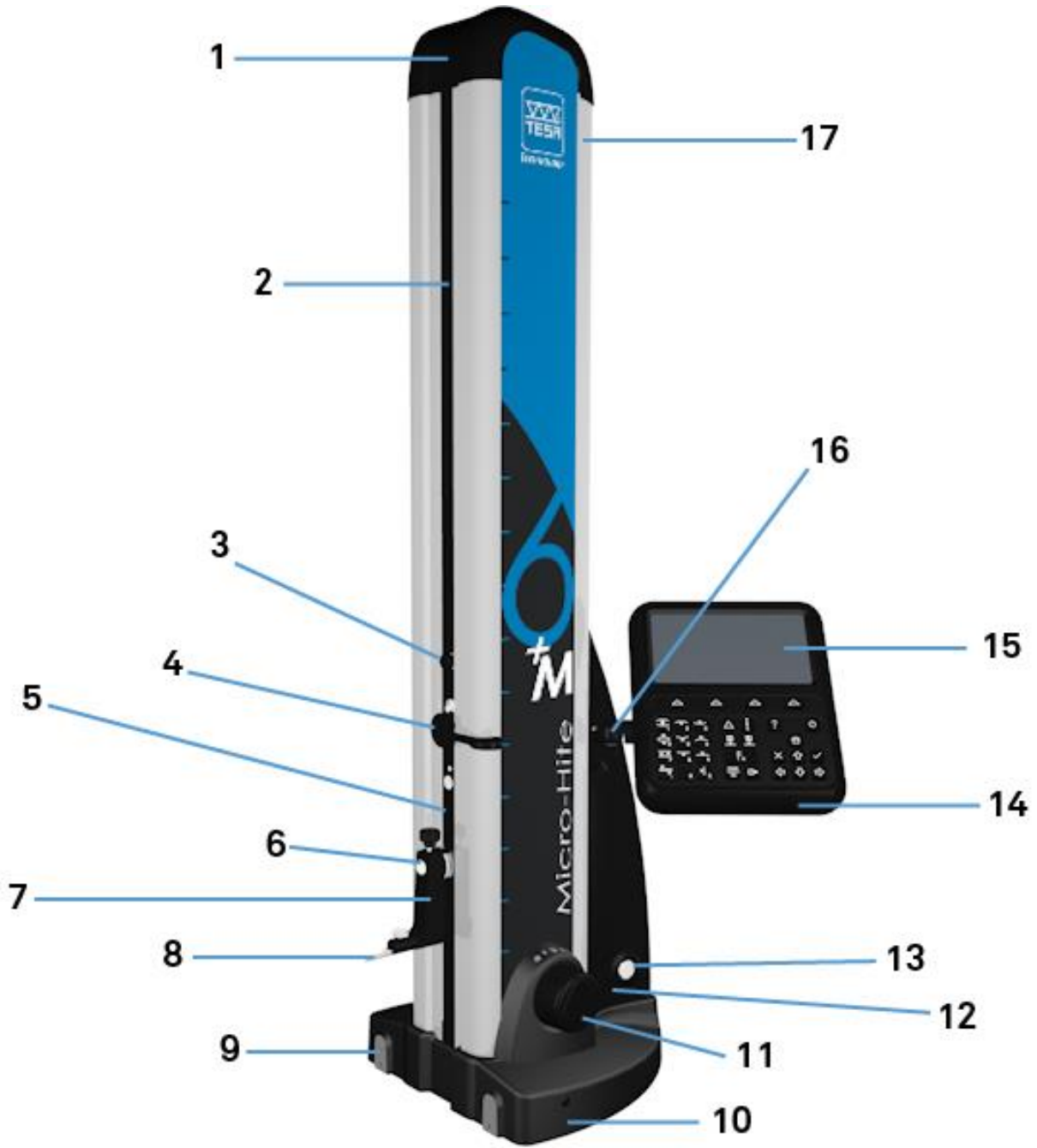
Fig. Description des éléments constitutifs du TESA MICRO-HITE+M
