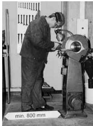
Un passage de 800 mm doit être prévu pour permettre un travail sûr.
