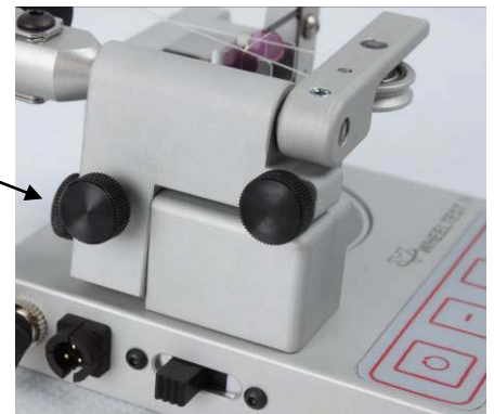
Vis de réglage de la position de la courroie
