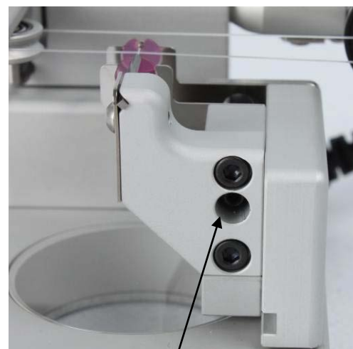
Vis de réglage de la distance entre les appuis
