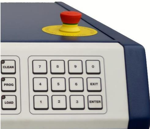
Er dient dazu, die mechanischen Teile der ACS 900 im Gefahrenfall oder zur Abwendung einer Gefahr schnell in den Stillstand zu versetzen.
