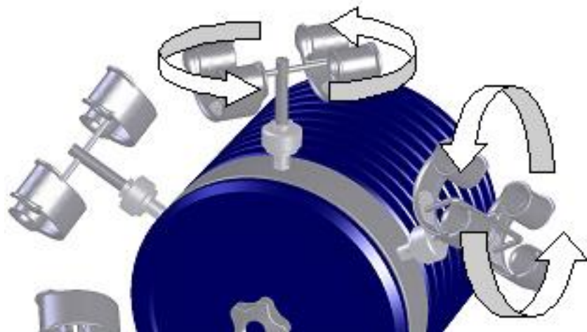
illus. 3.6.2. bride avec remontage dans un sens, en fonction du sens de rotation
