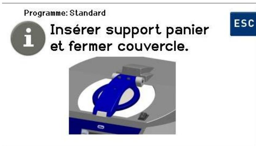
Fig. 6.3.2 Écran *Insérer support panier et fermer couvercle*
