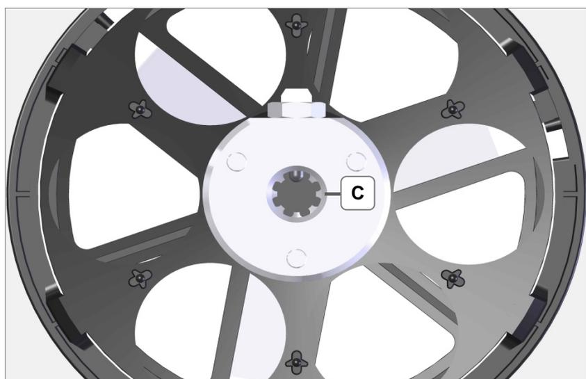
Fig. 9.2.3.3 Face inférieure du support panier / emplacement de la douille à collet
