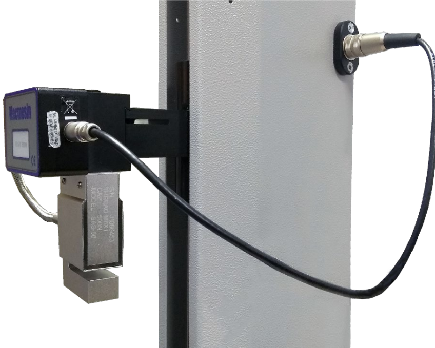
▲ Connecting the 6-pin plug to the ELS
