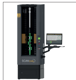
SCAN S145L Messbereich Ø 145 mm / L 1280 mm
